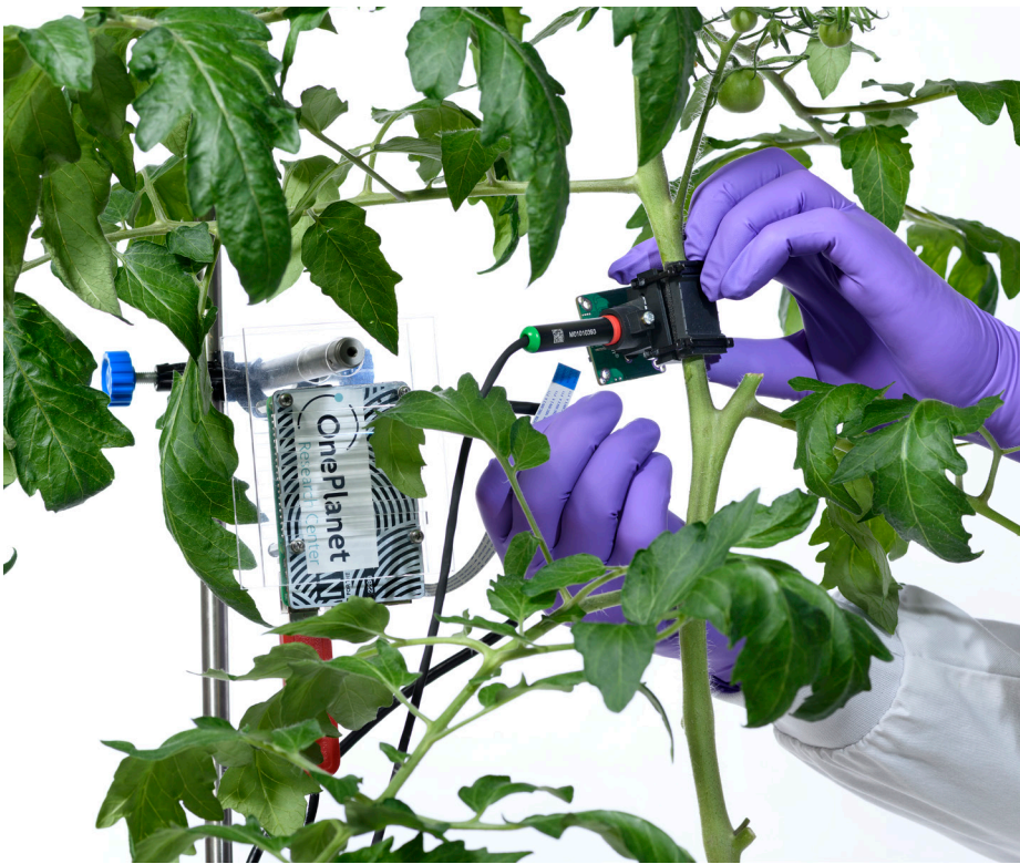
Laser-speckleapparaat, gebaseerd op fotonicatechnologie, bevestigd aan een tomatenplant voor het monitoren van de gezondheid in de plant - OnePlanet Research Center
